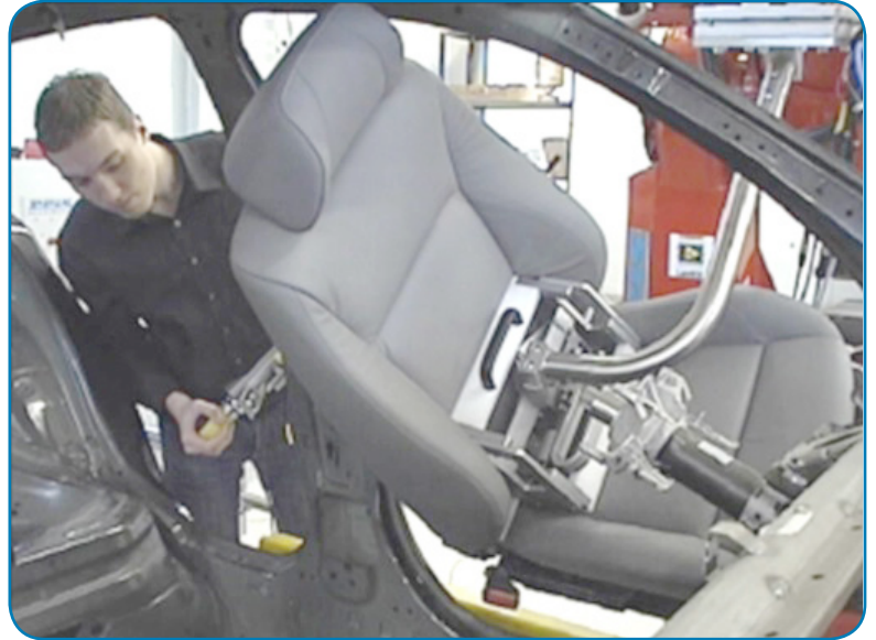
Abbildung 3: Montage eines Autositzes in der Karosserie; der Roboter trägt das Gewicht des Sitzes, während der Mensch ihn bei den komplizierten Einfädelprozess an die Endposition führt.
